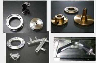
各種部品加工、金型部品(焼入れ、研磨)等にも対応
